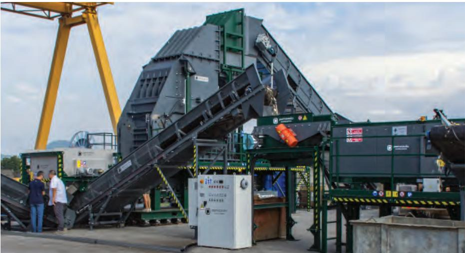
do importanti flussi di rottami da valorizzare, ha scelto la sicurezza del nostro mulino a martelli Mega 1500".
