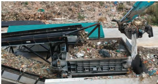
Per il MSW Forrec realizza impianti in grado di ridurre i passaggi nella preparazione del materiale, garantendo un output di qualità con un tritratore primario (multilaceratore FR) e un vaglio, evitando la macinazione secondaria causa di alti costi di
