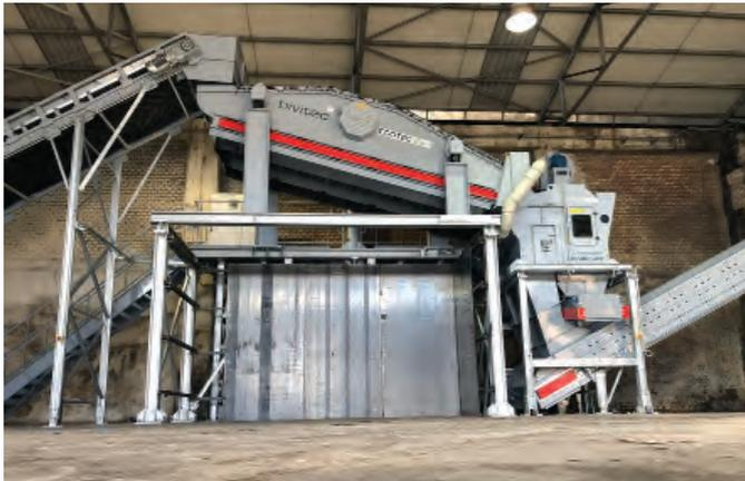
teriale. La granulometria del materiale in entrata è compresa tra 0 e 150 millimetri e la sua densità è di circa 0,6 t/m<sup>3</sup>. I piani vaglianti della macchina sono dotati di fori quadrati da 60 millimetri. In questo modo il sopravaglio viene separato e viene immesso nuovamente nel processo di maturazione mentre il sottovaglio, di dimensione uguale o inferiore ai 60 millimetri, prosegue verso la fase successiva del processo: la raffinazione.
