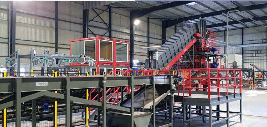
re un prodotto di dimensioni variabili da 50 a 80 mm per l'impiego come combustibile nelle cementerie, lo pneumatico viene tagliato di netto senza sfilacciare l'acciaio in esso contenuto.
