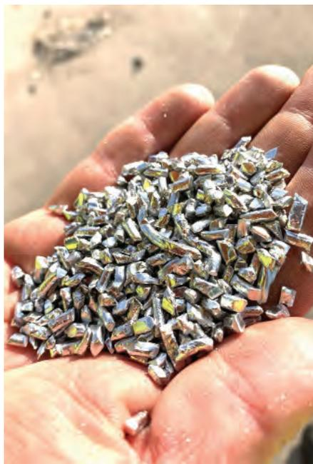
La rotazione lenta, associata ad un'elevata coppia, permette di tritare questo materiale con un limitato consumo energetico, ma non solo. La presenza di una griglia di vagliatura collocata sotto i rotori, consente di avere un output dimensionato ad una pezzatura tale da agevolare il lavoro dell'impianto di granulazione e separazione a valle, con il grande beneficio di ridurre tutti i costi operativi di manutenzione.
